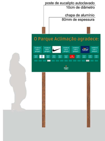
Modelo 1.1: Placa Identificativa única dos colaboradores/doadores de Bens e Serviços Desenho técnico cotado em escala 1:15 e desenho humanizado, folha 01 de 05
